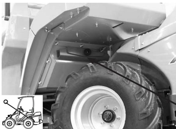
Säkra lastarmen genom att sätta lastarmstödet på kolvstängan på lyftcylindern.
