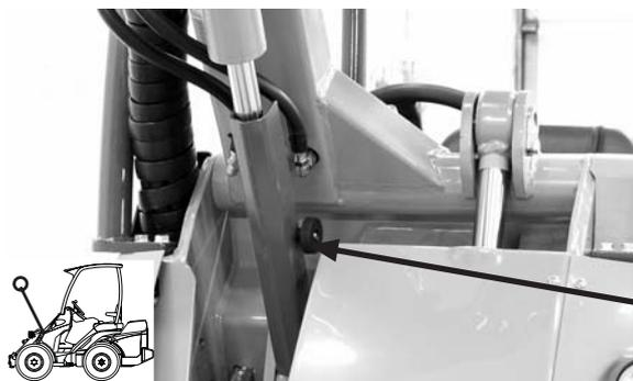
Säkra lastarmstödet med bulten varmed stödet är monterat på framramen.
