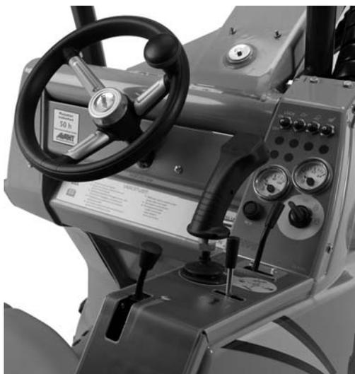
AVANT 400-seriens lastare är utrustad med variabel hydrostatisk drivning. Det betyder att drivpumpens oljeflöde kontrolleras steglöst med drivpedal, då lastarens rörelser är mjuka och exakta och det inte heller har någon risk att överbelasta lastarens hydraulsystem på något sätt.
