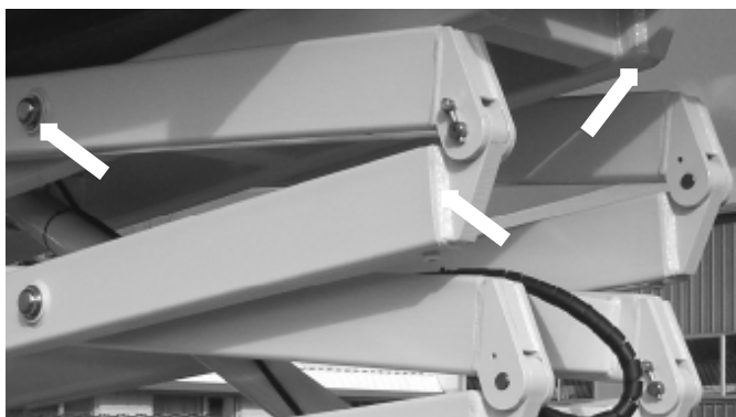
Fig. 7.19 - Skador på konstruktion och svetsar
