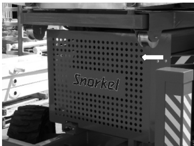
Fig. 2.11 - Saxskydd, i framkant på maskinen
