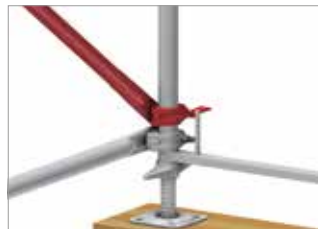
Bild 13: Montera Vertikal-diagonalen i den nedre delen
