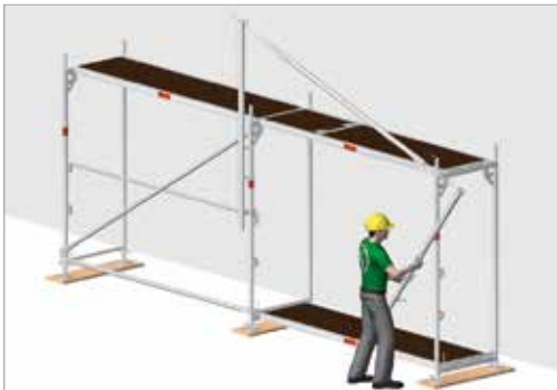
Bild 73: Montering av de andra MSG räckesfästet i MSG stolpen
