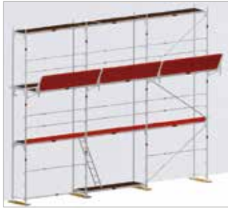
Bild 52: Plattform på skyddstak
