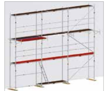
Bild 49: Montage av plattformarna i hakarna med 0,73 m, med aluplan som täcker in mellanrum
