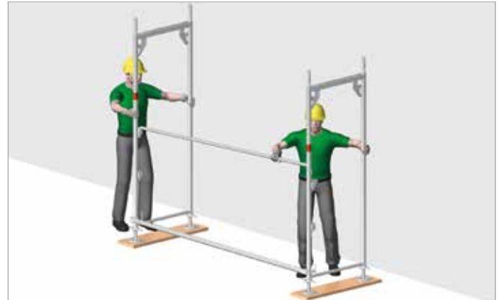
Bild 8: Montering av det första planet: Skyddsräcke, horisontalstag
