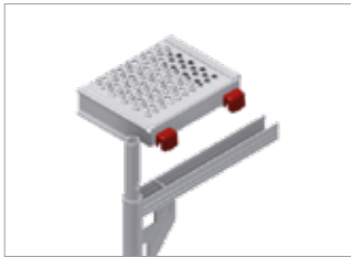
Bild 14: Haka fast stålplank
