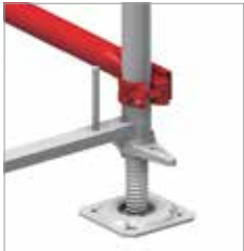
Bild 10: Montage av horisontalstag
