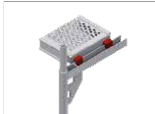
Bild 15: Stålp plank fasthakad i ram placerad inuti förskjutningsskydd
