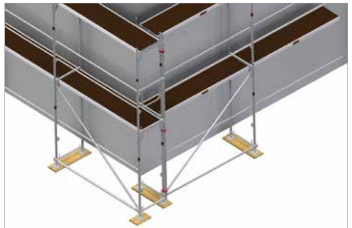
Bild 33: Hörnformation vid övriga ställningsnivåer
