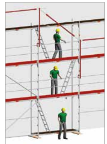
Bild 29: Montera upp MSG skyddsräckesmontagestag
