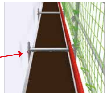
Bild 58: Skyddsnet på monteringsram (detaljbild)
