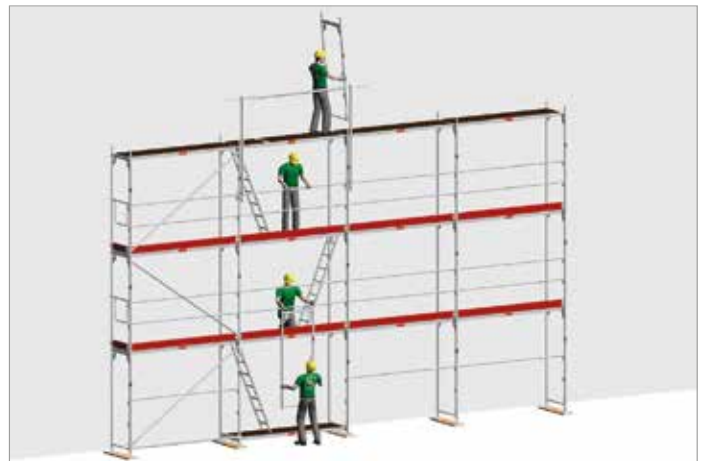
Bild 31: Montering av tillträdesfack med skydd av MSG
