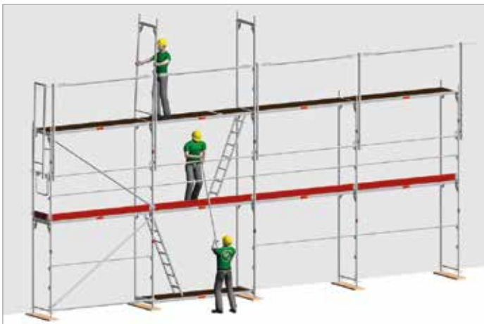
Bild 26: Fortsätt montage av nivåer med skydd av MSG
