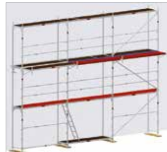
Bild 50: Plattform med mellanrums intäckning
