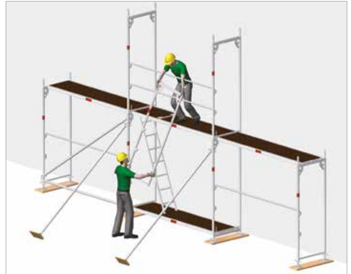
Bild 2: Exempel på ett tillfälligt lutningsskydd med installation på det andra bomlaget.
