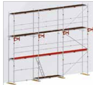
Bild 48: 0,73 m konsol som skyddande takfäste på ställningens yttersida
