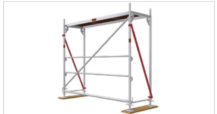
Bild 16: Ställningsfack med tvärgående diagonaler
