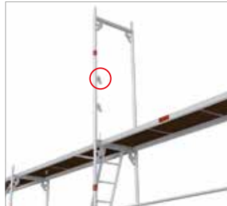
Bild 85: Antagbar förankringspunkt för PFU vid monteringsramens kilplatta över \geq 6,00 m
