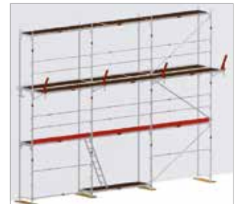
Bild 51: Montering av Skyddstak
