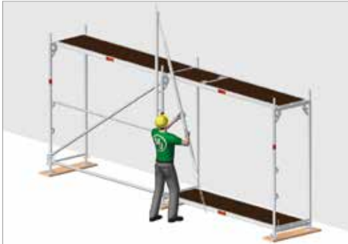
Bild 72: Montering av MSG räck i MSG stolpen
