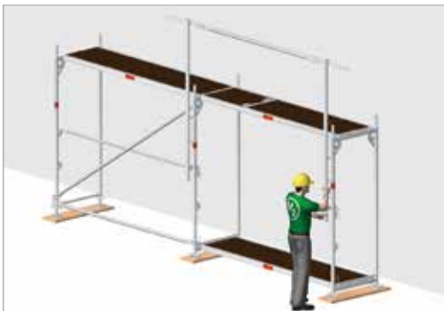
Bild 74: Montering av den andra MSG stolpen
