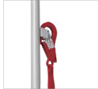
Bild 86: Förankringspunkt i monteringsramens kilplatta
