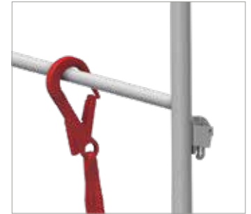
Bild 80: Förankringspunkt i det övre skyddsräcket
