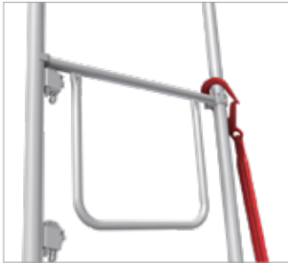
Bild 84: Förankringspunkt i monteringsramen ovan gavelräcket (kopplingsidan)
