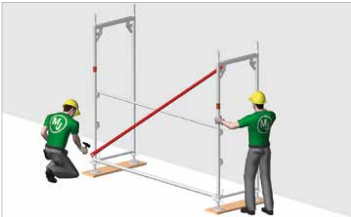
Bild 11: Montering av det första bomlaget: Vertikal-diagonal
