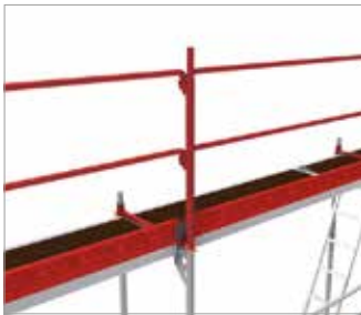
Bild 41: Översta bomlaget med skyddsräcken med räcesstolpe L-bom horisontalstag och sparklister
