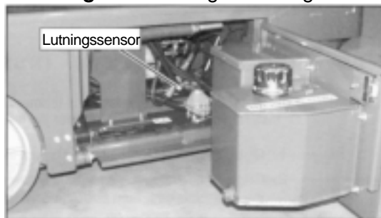
Fig. 3: Placering av lutningssensor
